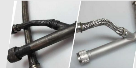
Línea de tubería hidráulica limpia
