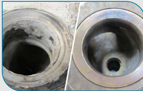
Residuo de gas de vertedero eliminado de la culata
